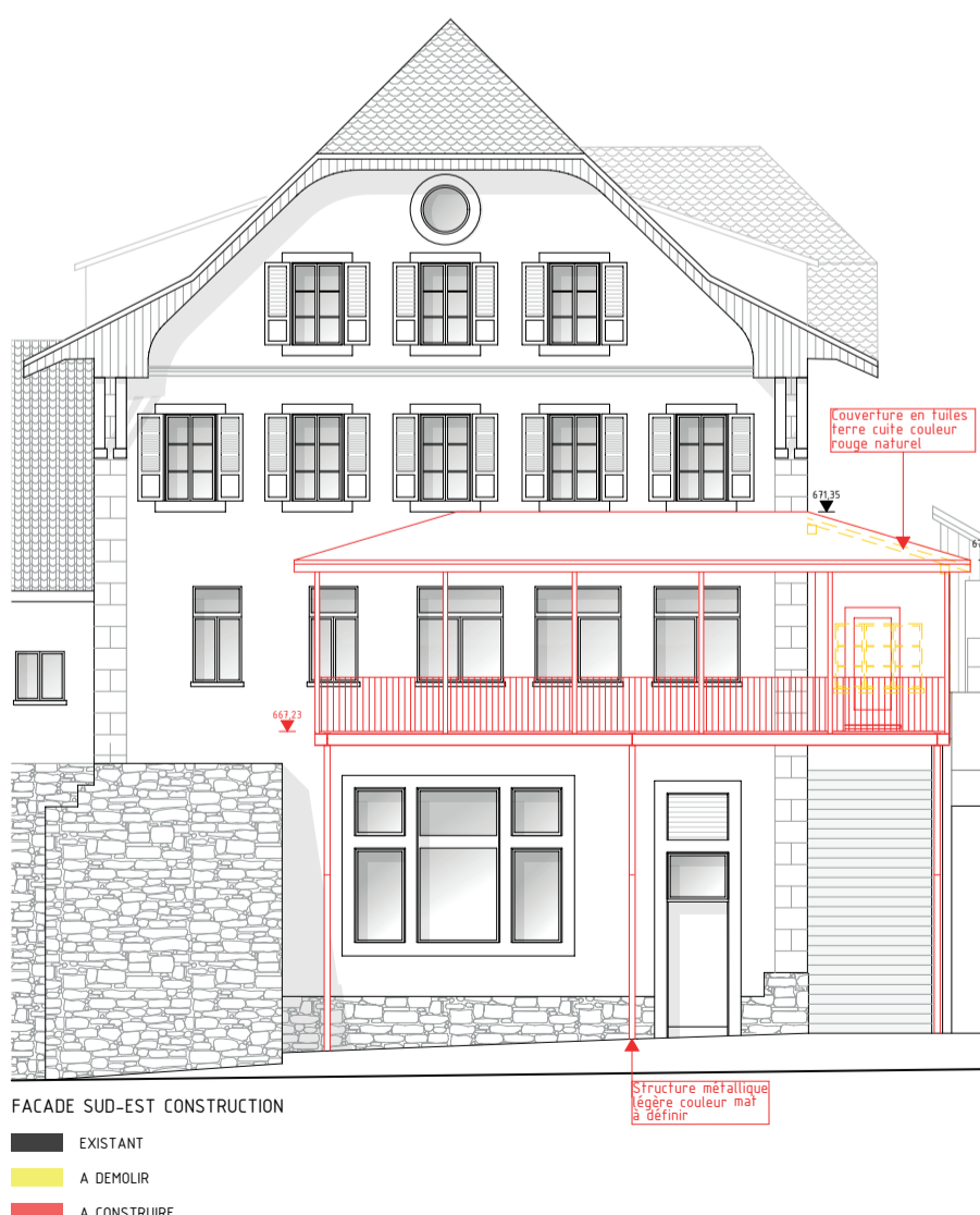
Plan de la terrasse à construire, façade sud-est © Architecte atelier-nsb Sàrl - Natalia Sevillano Bravo
